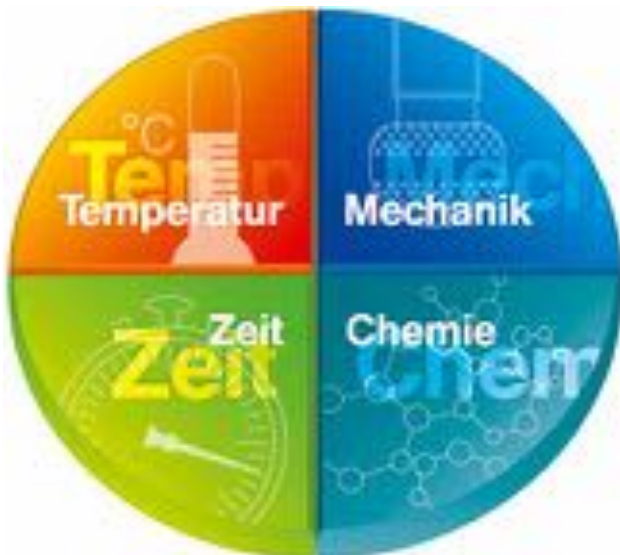
Abbildung 1: Sinnerscher Kreis mit gleichmäßigen Anteilen der Faktoren Temperatur, Zeit, Chemie und Mechanik.
