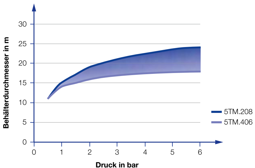
Übersicht des Behälterdurchmessers in Abhängigkeit des Drucks der Baureihe 5TM
